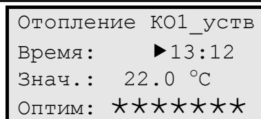
Рис. 20. Отображение/конфигурирование времени, значения и оптимизация физической точки расписания «Daily» (Суточное)
