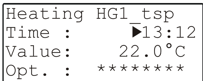
Рис. 19. Отображение/конфигурирование времени, состояния и оптимизация информационных точек расписания «Daily» (Суточное)
